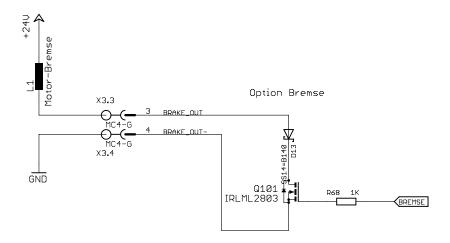
Ermöglicht die automatische Ansteuerung einer Motorbremse abhängig vom Enable-Signal. Die meisten Bremsen arbeiten mit 24V, die extern zur Verfügung gestellt werden müssen. Ein Anschluss der Bremse wird fest mit +24V verbunden, der andere Anschluss mit X3.3. X3.4 wird mit Masse verbunden. Der Motor wird betromt, bevor die Bremse gelüftet wird. Umgekeht wird beim Abschalten der Endstufe erst die Bremse aktiviert, bevor der Motorstrom abgeschaltet wird.
