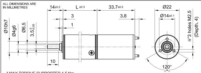
\* MAX TORQUE SUPPORTED 1,5 Nm
