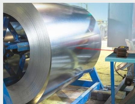
Mesure de diamètre de bobines
