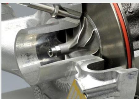
Mesure de vitesse de rotation des turbocompresseurs
