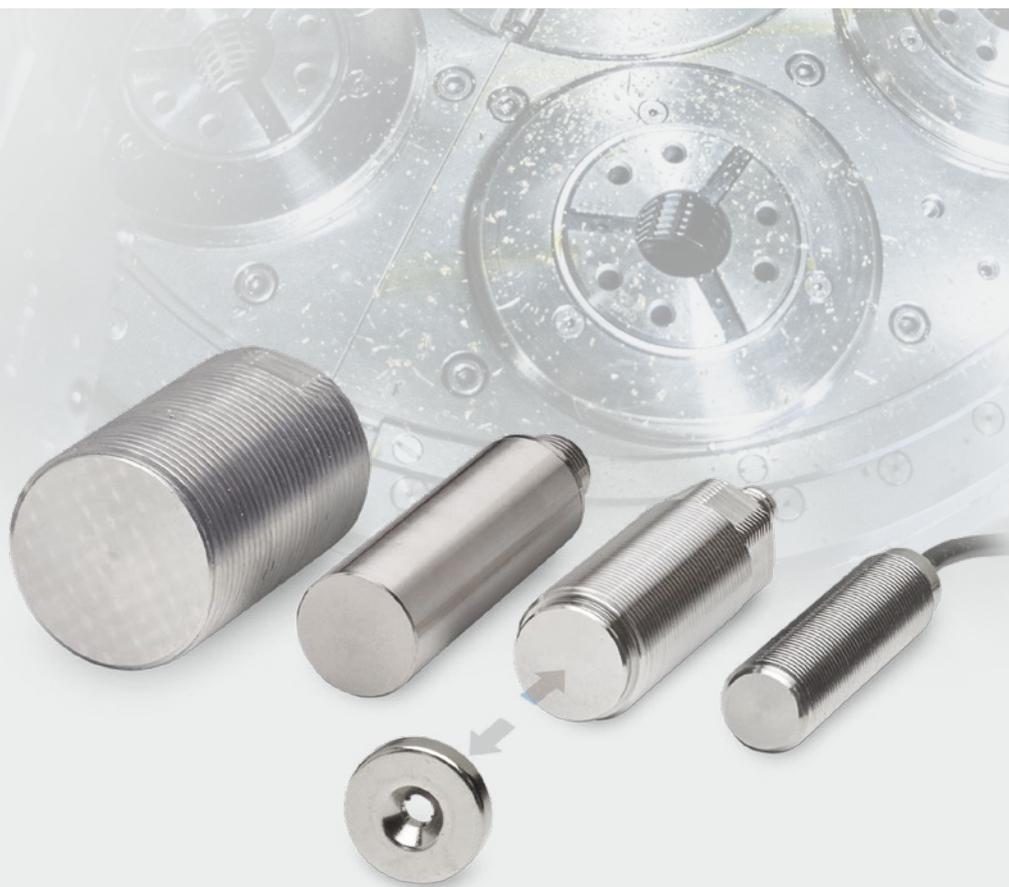
Les capteurs de distance mainSENSOR font appel à un principe de mesure innovant en combinant les avantages des capteurs inductifs et ceux des capteurs magnétiques. Le capteur mesure la distance par rapport à un aimant fixé à l'objet de mesure et délivre un signal de sortie linéaire en continu. L'utilisation d'aimants de différentes puissances permet d'obtenir des plages de mesure entre 20 mm et 55 mm. Il suffit de remplacer un aimant pour définir la plage de mesure.
