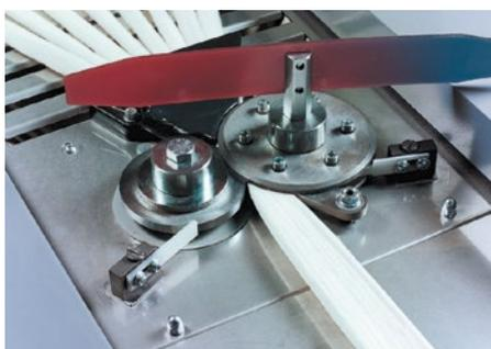
Mesure de l'épaisseur des fuseaux de fils
