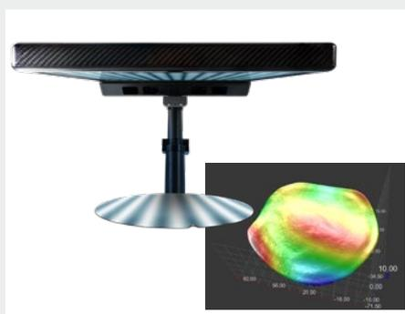
Détection de la forme 3D des wafers
