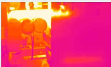
Surveillance de température dans le laminage à chaud
