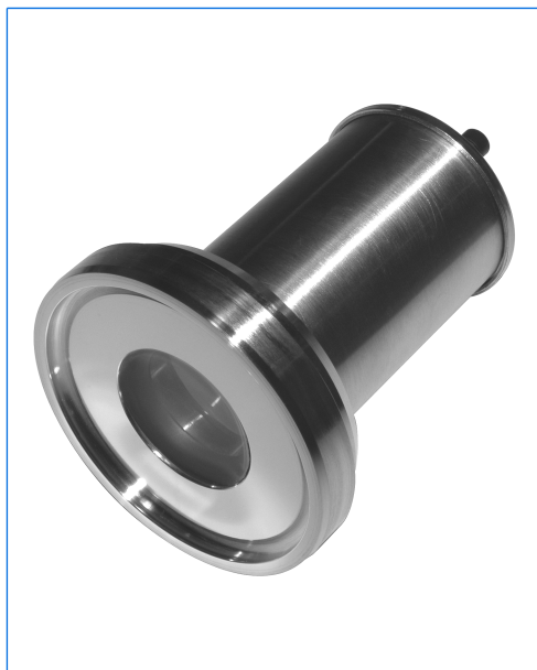
Projecteur miniLUX STERI-LINE, type BKVLR DA LED, ca. 2 W, 24 V, monté sur hublot à verre moulé selon DIN 11864-1
