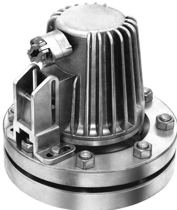
Type F 20 dHSchU, Ex d IIC T5 Gb, Ex t IIIC T95°C Db IP67, Ex II 2 G + D, ampoule halogène, 230 V, 20 W, temporisation «U» incorporée, sur hublot selon DIN 28120, DN 125, PN 10, fixation par charnière «Sch».
