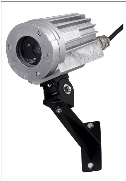
Caméra adf Vario, enveloppe en alliage d'aluminium, Ex d IIC T6, Ex tD A21 IP67 T80°C, Ex II 2 G + D, avec fixation murale.
