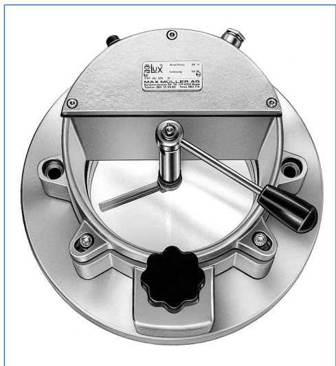
Hublot éclairant-voyant, type KSGB 125, tension d'alimentation 24 V, puissance 50 ou 100 Watts, avec essuie-glace de la gamme W.
