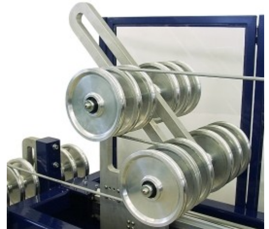
Schlitten der Flextestmaschine
