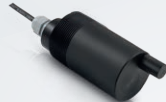
OPTISENS TUR 2000 Sonde de lumière diffuse à 90° pour la mesure de turbidité avec NIR-LED pour une grande stabilité dans le temps et un nettoyage automatique
