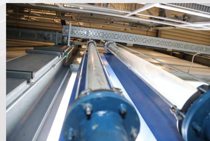
通过玻璃管路进行视觉控制 Glasmade pipes for optical control
