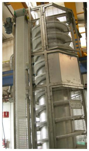
I sistemi a Spirale M.H. realizzati con catena modulare in plastica sono la soluzione più versatile per molteplici applicazioni:
