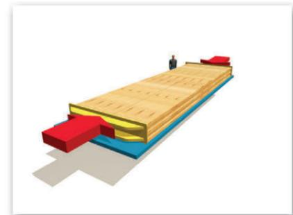
Stirnseitendruck bis / *Frontside pressure up to  $240 \text{ kN} = 0,5 \text{ N/mm}^2$  bei / at 200 mm Stärke und / thickness and 2.400 mm Breite / width.*
