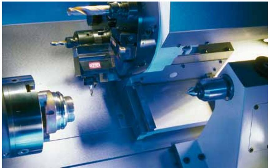
Une zone de travail largement dimensionnée et une tourelle revolver à 12 récepteurs d'outils à indexage rapide. Alimentation interne de liquide de refroidissement et logique de direction en font bien sûr partie.
