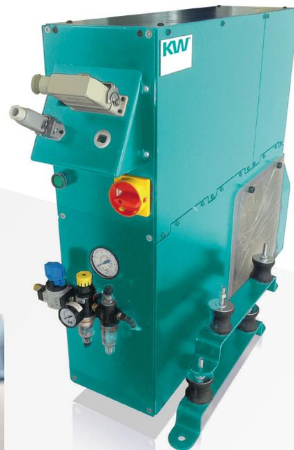
Kontrolle ist gut, Soll-/Ist-Abgleich besser. KW VD 01 prüft die wichtigsten Parameter bei bentonitgebundenem Formstoff für eine höhere Rentabilität.
