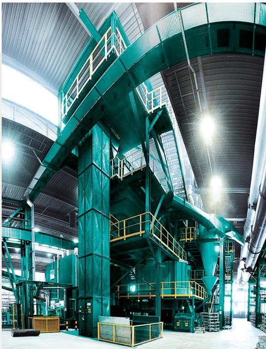
Sei es bei der Konditionierung, der Bunkerung von Altsand oder der Formsandaufbereitung bis hin zur zukünftig immer wichtiger werden Sandregenerierung: Eine leistungsfähige Sandaufbereitungsanlage ist für die zuverlässige und kostengünstige Gussherstellung von
