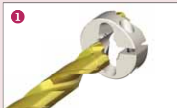
1. Inserire l'anello sul corpo punta I fermi devono essere all'interno dell'elica.
