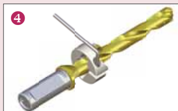
4. Bloccare l'anello con una forza di serraggio di 3 - 4 Nm
