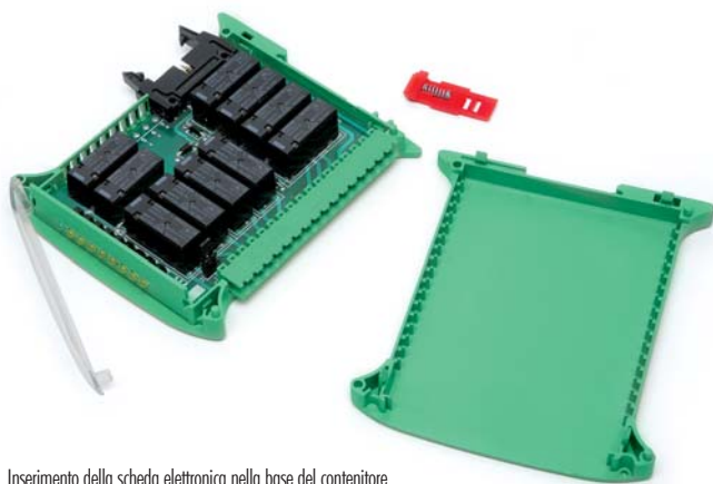
Inserimento della scheda elettronica nella base del contenitore. Insertion of the PCB into the base of the enclosure.
