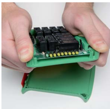
Estrazione della scheda elettronica. Removing the pcb.
