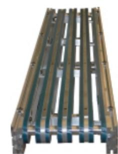
Convoyeur Type 920 avec courroie huit voies
