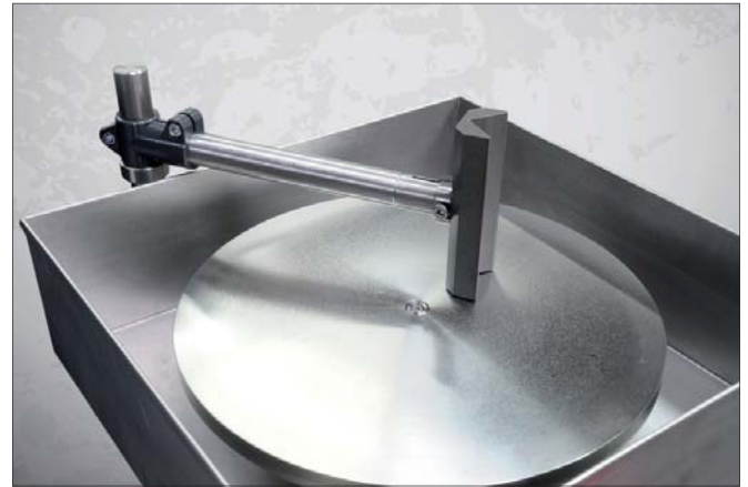
551 W mit Winkelschleifvorrichtung 551 W with angular grinding attachment
