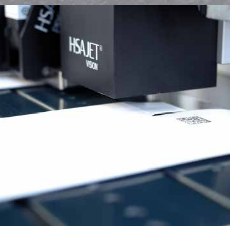
Caméra d'inspection avec vérification du code et classement.
