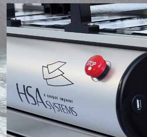
Arrêt d'urgence placé à l'avant de la machine, sur le côté droit.
