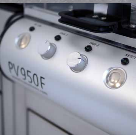
Boutons contrôlant la mise en route de l'ordinateur, l'arrêt d'urgence, la réinitialisation et le ventilateur situés à l'avant de la machine.
