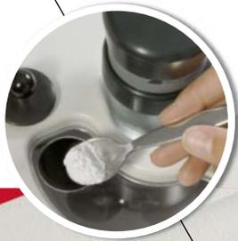
**FRITSCH-Plus** Einfache Einstellung und Nachjustierung des **Pistilldrucks auf die Mörserschale** – zur optimalen Zerkleinerung.
