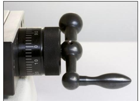
**Besonders exakt:** der Präzisions-Schiebetisch der FRITSCH Scheibenmühle PULVERISETTE 13 *classic line* zur präzisen Spalt-einstellung mit 0,1 mm Genauigkeit – für schnelles, genaues Arbeiten und exakt reproduzierbare Mahlergebnisse.
