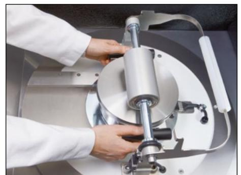
**Besonders ergonomisch:** In optimierter Arbeitshöhe werden die in ihrem Gewicht enorm reduzierten Mahlgarnituren der PULVERISETTE 9 einfach auf eine praktische Führungsleiste gesetzt und in die Endposition geschoben.
