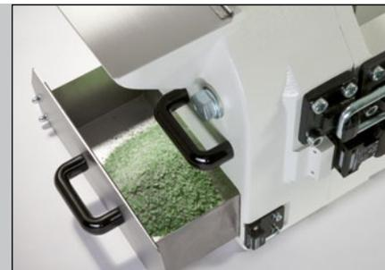
Mahlergebnis bei Spaltweite 1 mm
