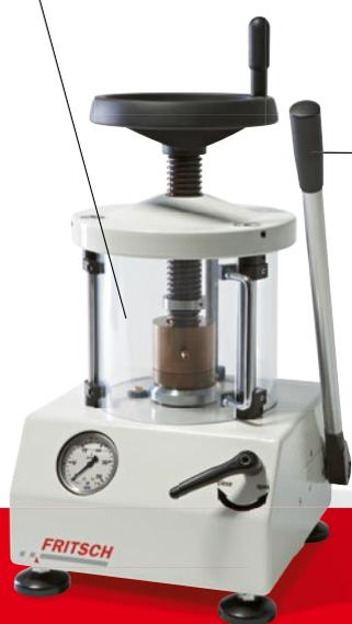
**Einfach:** Mit einem Herunterdrücken des Handhebels erzeugen Sie einen stabilen, hoch durchlässigen Pressling für die weitere Untersuchung.
