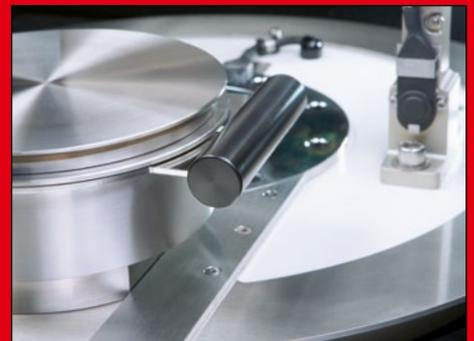
**Besonders leicht:** Die Mahlgarnituren der neuen PULVERISETTE 9 sind deutlich leichter und mit wärmeisolierten Tragegriffen ausgestattet.
