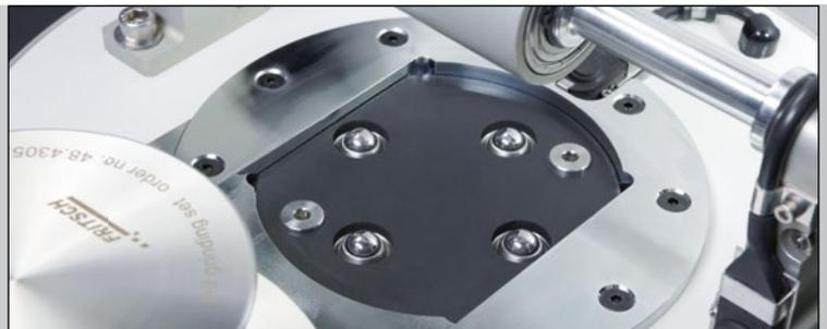
Druckstücke heben die Mahlgarnitur automatisch an, die Verdrehsicherung verspannt sie absolut sicher und der Sicherheitsschalter prüft den Sitz.
