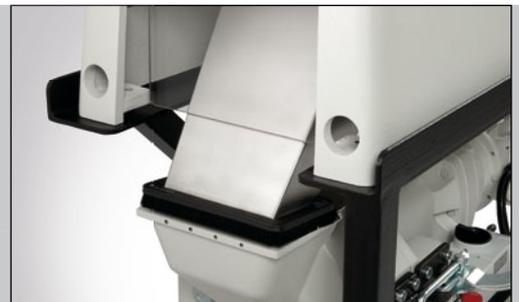
Eine Verbindungsschütte leitet das vorzerkleinerte Mahlgut automatisch zur Feinzerkleinerung weiter.
