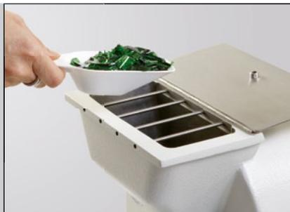
Befüllung des Trichters mit vorzerkleinerten Glasflaschen
