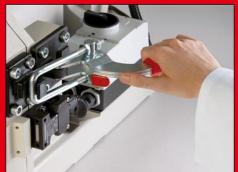
**Besonders sicher:** der zentrale Spannverschluss der Mahlkammer
