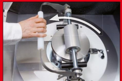
**Besonders sicher:** Die völlig neue Schnellspannung der Mahlgarnitur – mit einer Hand und einem Handgriff in Sekundenschnelle verdrehsicher fixiert.
