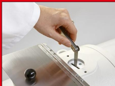
**Besonders praktisch:** bequeme Spaltweitenkontrolle von außen (z. B. mit Fühlerlehre)
