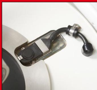
**Besonders intelligent:** Ein spezieller Detektor erkennt automatisch, wenn Sie für die Mahlung eine Achat-Garnitur verwenden und reduziert selbstständig die Drehzahl.
