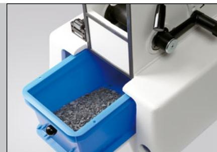
Kraftvolle Zerkleinerung: grobes Basaltgestein zerkleinert die PULVERISETTE 1 classic line (Modell I) auf Spaltposition 2 zur im Auffanggefäß rechts gezeigten Endfeinheit.
