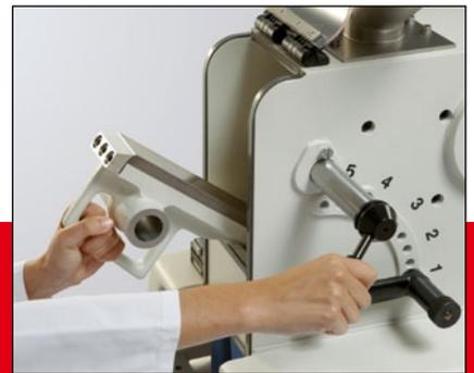
Spart Zeit und Arbeit: **Die besonders einfache Brechplattenentnahme** in Sekundenschnelle mit nur 2 Handgriffen sorgt auch für besonders einfache Reinigung – schnell und gründlich.
