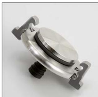
Le joint torique solidaire du couvercle assure une étanchéité absolue totale des bols de broyage *premium line*, aucune précaution supplémentaire n'étant à prendre pour les échantillons en suspension.
