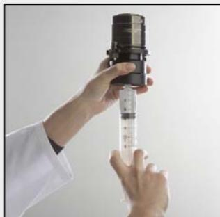
Après le broyage en suspension, le dispositif spécial de récupération FRITSCHE avec 2 tamis permet une séparation rapide et facile des billes et de la suspension du broyat. Pour cela, le dispositif s'attache fermement sur le bol de broyage, et la suspension est retirée grâce à la seringue et les boules restent sur les tamis.
