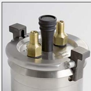
Le couvercle *premium line* avec double valve permet le broyage sous une atmosphère contrôlée et la mécanosynthèse – rapidement et sûrement.
