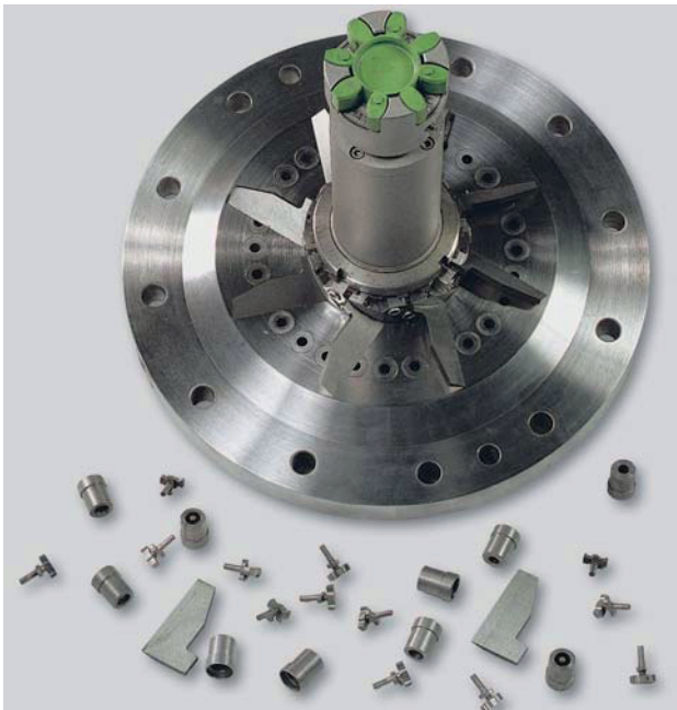
Particolare trafilatura ed inserti Detail die plate and inserts
