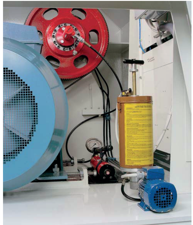
Ingrassaggio automatico cuscinetti principali e pompa estrazione viti
