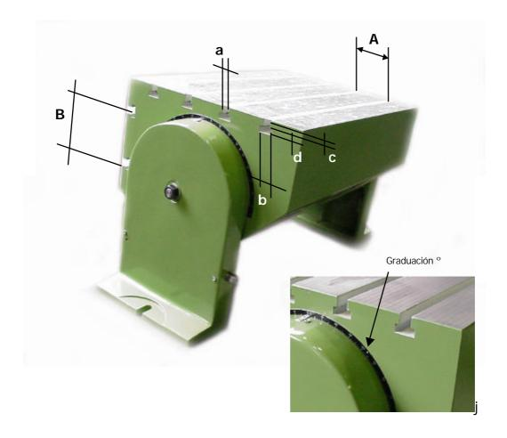
Graduadas y con 2 superfícies útiles angulares ranuradas en T que pueden variar A voluntad hasta 180º, por medio de tornillo sin fin y con regleta milimetrada.
