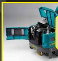
Toutes les pièces et les moteurs sont facilement accessibles pour leur entretien, car les panneaux frontaux, latéraux et postérieurs peuvent être totalement ouverts. Les batteries (version EB) peuvent être remplacées en toute simplicité et très rapidement grâce à un chariot spécial.
