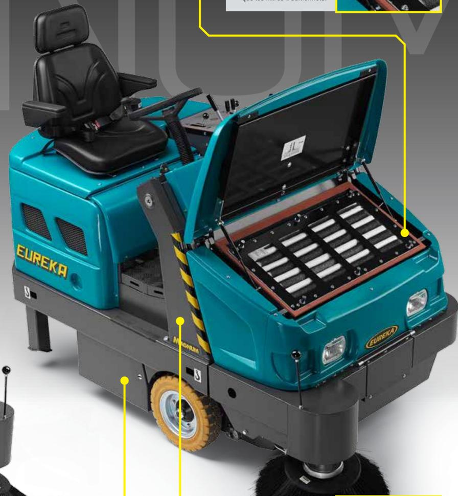
Le bac à déchets antérieur peut être soulevé hydrauliquement jusqu'à 1.540 mm. Il flotte au sol et se règle automatiquement, pour permettre un balayage plus facile des déchets les plus volumineux.
