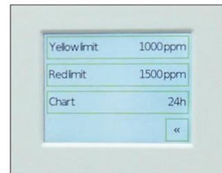
Verschiedene Display-Einstellungen möglich, z. B. Ansicht CO<sub>2</sub>-Kurve (1), Schwellwerte gelb & rot (3), Messwerte: CO<sub>2</sub> · Temperatur · relative Feuchte auf einen Blick (2), etc.
