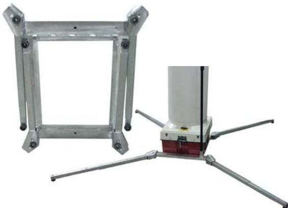
Sistema di installazione su superfici d'asfalto con struttura in alluminio a bracci estensibili e punti di ancoraggio. Ottimo per installazioni in centri urbani ed aeroporti. Dimensioni chiuso: 53x67x7 cm. Dimensioni aperto: 340x340x7 cm. Tempo di installazione 120 secondi
