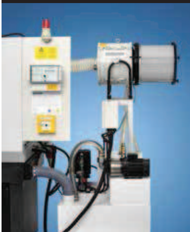
Externe Ölfilteranlage mit Behälter und Hochdruckpumpe. Rauch- und Ölnebelabsauganlage (Option)
