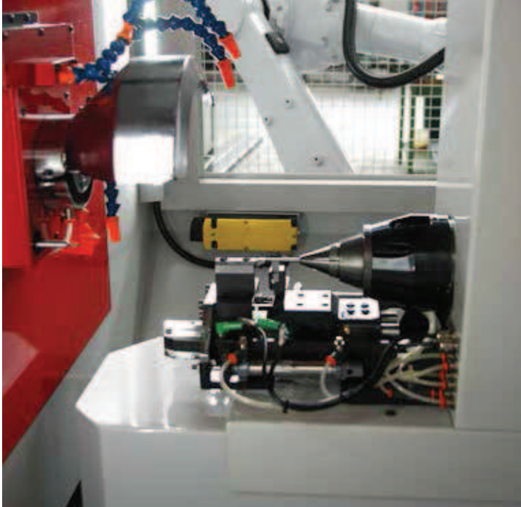
Lünette und automatischer Reitstock zum Nachschleifen oder zur Herstellung kleiner Werkzeuge (Option)
