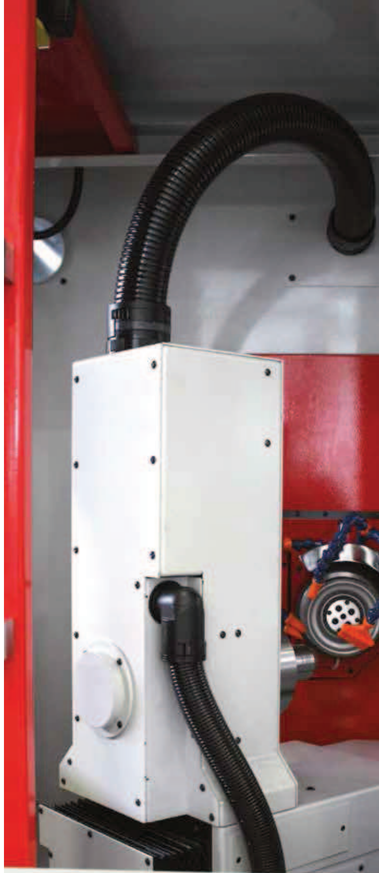
Lünette und automatischer Reitstock zum Nachschleifen oder zur Herstellung kleiner Werkzeuge (Option)
