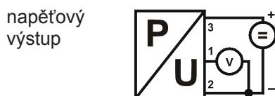
**Přiřazení vývodů:** platí pro konektor DIN 43650C
