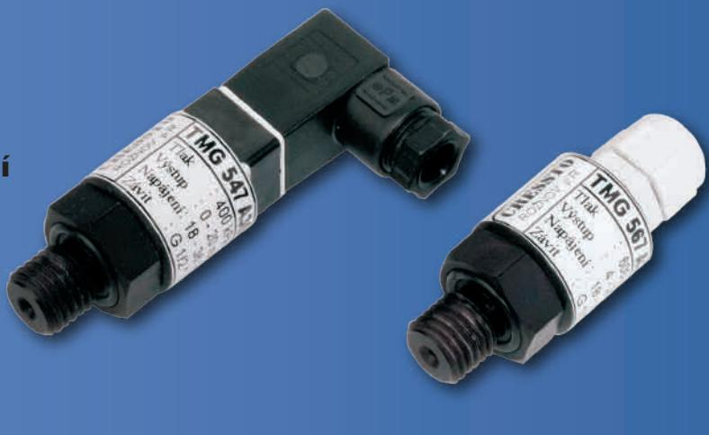
Snímače této řady jsou určeny pro měření relativního přetlaku i podtlaku v kapalných i plynných médiích neagresivního charakteru. Jsou určeny především pro přístrojovou techniku, zejména pak pro aplikace pracující s nízkým napájecím napětím. Vzhledem k malé vlastní spotřebě je lze použít v aplikacích napájených z baterií. Tyto snímače nejsou vhodné pro aplikace v oboru energetiky, vytápění, vodárenství ap.
