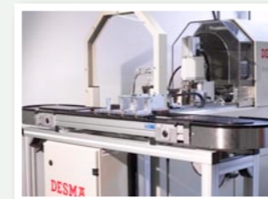
Automatisierungsstrecke zur Integration in vor- oder nachgelagerte Produktionsprozesse wie Handhabungs-, Montage- oder Fügeaufgaben.
