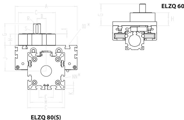
Bei Baugröße 60 ist eine Montageplatte auf dem Schlitten montiert.
