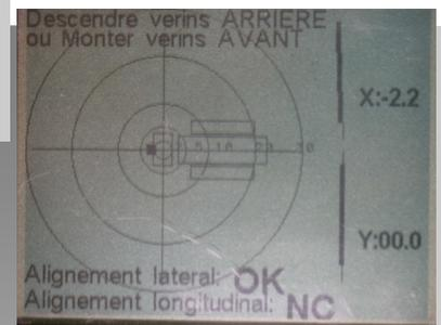
L'inclinomètre donne des instructions pour la mise en place précise de la flèche
