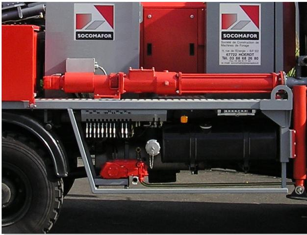
Placée sur le coté de la machine, les pompes sont faciles d'accès et d'entretien. Le circuit d'injection est composé de clapet s'anti-retour permettant travailler avec une ou l'autre pompe ou les deux en même temps.
