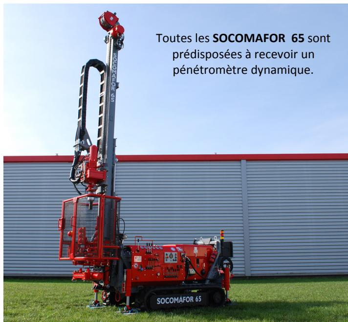
Toutes les **SOCOMAFOR 65** sont prédisposées à recevoir un pénétromètre dynamique.
