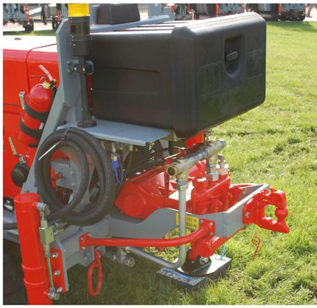
Placé à l'arrière de la machine, la pompe est facile d'accès et d'entretien. Le support de crochet pour remorque sert de protection.
