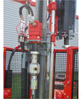
Equipée de la tête d'injection sortie 60 ou 50 cralius mâle, la Socomafor 15 permet de travailler à l'injection au tricône ou bien de carroter avec la tête grande vitesse.
