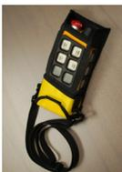
Radiocommande de déplacement pour plus de vision et de confort donc plus de sécurité pendant les manœuvres
