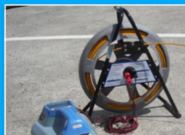
S'il est reconnu pour sa simplicité d'utilisation, le RD8000 n'en demeure pas moins un outil extrêmement complet. Il est ainsi possible d'y adjoindre plusieurs accessoires en option, tel qu'un connecteur de câbles BT sous tension pour les branchements clients ou la FlexiTrace pour aiguiller fourreaux, branchements gaz ou eau en PE... La pince d'émission 100mm, et les batteries rechargeables restent les options les plus appréciées par nos clients.
