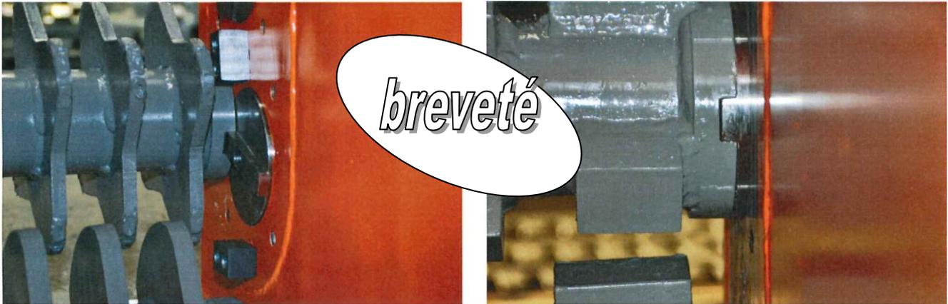
L'accouplement rapide „Quick“ a été spécialement conçu pour permettre un remplacement facile des rotors. Cela permet un remplacement des rotors sans démonter les paliers ou les chaînes. Sur les deux faces, seule une vis doit être desserrée et le rotor peut être retiré.
