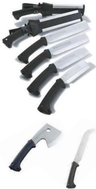
La gamme NATA se décline en 4 longueurs et 2 types de lames : Single Edge aiguisée sur un côté pour la coupe de petites branches, le marcottage des haies, l'écorçage des arbres. Double Edge aiguisée sur les 2 côtés permet en plus de fendre le bois. La poignée Genki absorbe les chocs de frappe. Lame interchangeable sur demande.
