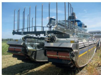
La flottaison est assurée par deux pontons creux en aluminium. Se déplace sur terre comme sur l'eau grâce à ses chenilles palmées.
