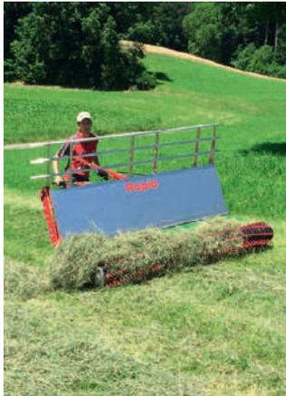
Le Rapid Multi-Twister dispose d'un convoyeur à bande avec lequel le produit de fauche récolté à l'aide du système éprouvé Pick-up est évacué activement sur le côté. Une utilisation sur terrain plat ou en pente est donc envisageable. L'évacuation active accroît en outre le spectre d'utilisation quant au fourrage vert et à l'ensilage. De même, le convoyeur à bande permet de mettre en oeuvre la technique de «l'andainage».
