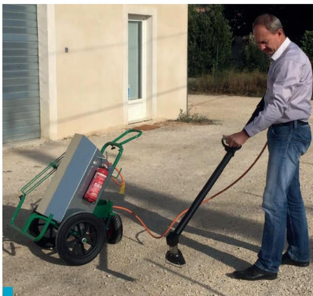
La lance peut être décrochée pour être utilisée portée pour le désherbage autour des arbres, des poteaux, des monuments funéraires, etc. (8 m. de tuyau).
