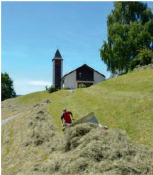
Les ramasse-foin Twister ont été spécialement conçus pour une utilisation en pente et permettent à l'opérateur du porte-outils mono-axe d'effectuer le travail habituellement lent et fastidieux de plusieurs personnes équipées de râteaux et de fourches.
