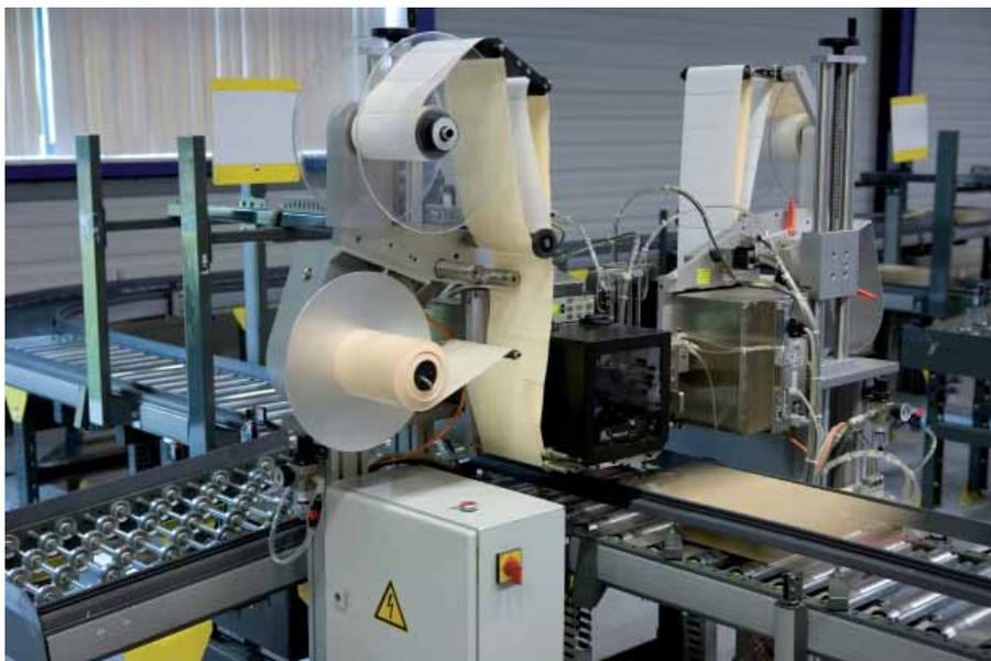
Machine d'étiquetage contrôlée par un automate programmable Série L.
