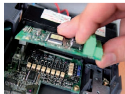
Connecteurs prévus pour un montage rapide
