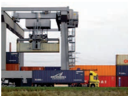
Les charges suspendues sont précisément positionnées grâce au moteur et au retour de codeur.
