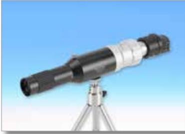
La puce de la caméra USB sera centrée en ajustant les réticules du logiciel Metric BE et de l'oculaire. Ce réglage se fait avec les trois vis six pans sans tête fixant l'adaptateur au corps du LDM. Le champ de vision est d'env. 4 mm pour une distance de 200 mm. Une distance de 2 000 mm fournit un champ de vision de 80 mm. Le pied montré dans l'illustration n'est pas livré
