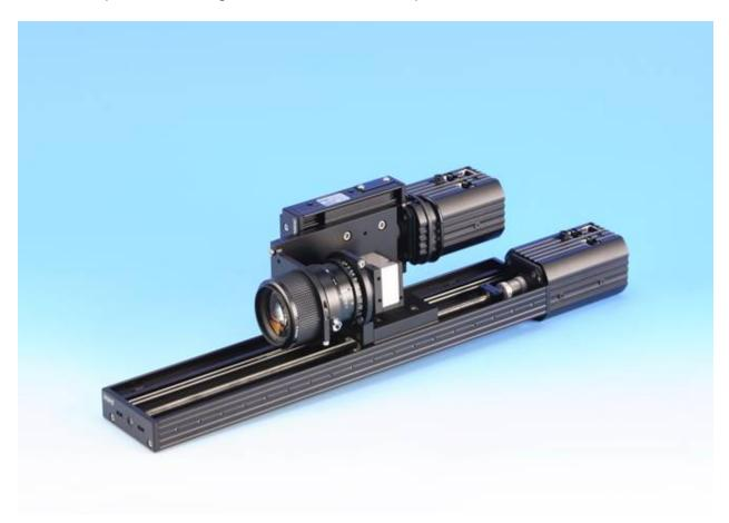
Le *TZS-1000-MOT* se compose de deux axes de déplacement. Un axe de 25 mm pour l'agrandissement et un axe de 300 mm pour la mise au point. Le facteur de zoom est d'environ 4:1. Le niveau de configuration avec changement automatique du convertisseur a un facteur de zoom d'environ 10:1. Les plages de zoom sont divisées en 10 niveaux pertinents par le logiciel de mesure Metric. (Modifications sur demande)
