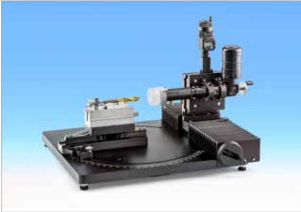
Le CT-12000 est le grand frère du CT-6000. Le système de mesure de longueur 250 mm (axe Y) a rendu nécessaire la conception d'un autre modèle de poste de mesure. Il est spécialement conçu pour les forets étagés de 50 mm et plus et pour les objets de géométrie similaire.
