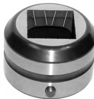
Photo 1 : Les rainures Mate Slug Free Light™ sont encochées et inclinées pour créer une série de bourrelets sur la chute. Lors du passage de la chute à travers la matrice, les bourrelets se trouvent coincés contre le bord de la matrice pour éviter tout retour de la chute vers la tôle. (Image retouchée pour une meilleure visibilité)
