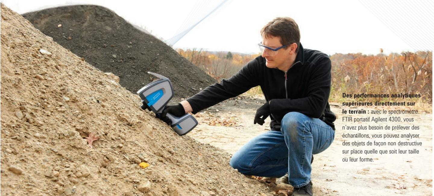
**Des performances analytiques supérieures directement sur le terrain :** avec le spectromètre FTIR portable Agilent 4300, vous n'avez plus besoin de prélever des échantillons, vous pouvez analyser des objets de façon non destructive sur place quelle que soit leur taille ou leur forme.
