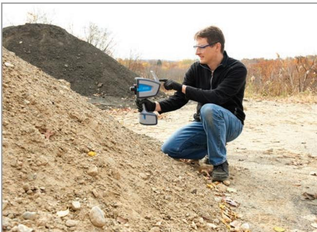
**Des commandes au bout des doigts** : un écran tactile intégré permet de commander toutes les fonctions du système et les fonctions d'acquisition des données. Il est inclinable pour faciliter le visionnage sous lumière ambiante.
