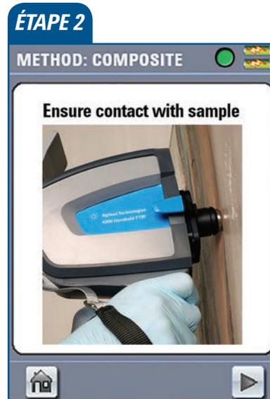
Le logiciel MicroLab Mobile vous indique à quel moment vous devez placer l'interface du spectromètre sur l'objet à analyser.
