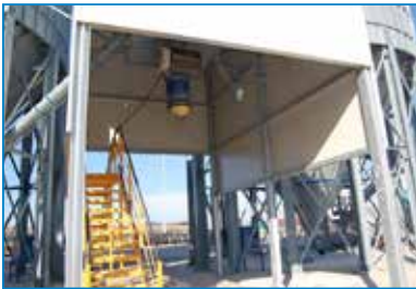
DETTAGLIO PUNTO CARICO AUTOCISTERNE
