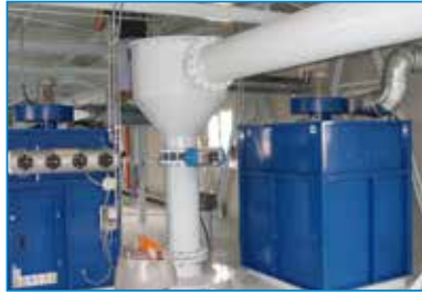
FILTRI DEPOLVERATORI AD ALTA EFFICIENZA HIGH EFFICIENCY DUST COLLECTORS
