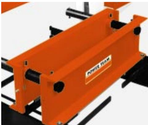
Breitenverstellung 102 bis 686 mm; mit Haltebolzen gesichert.
