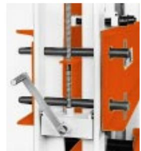
Hubspindel und Haltebolzen erleichtern Anheben des Pressenbettes.
