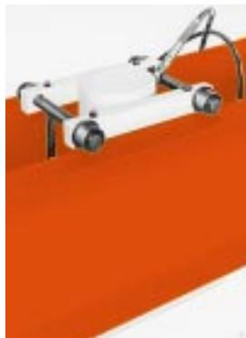
Druckzylinder leichtgängig über Gesamtbreite des Kopfträgers verschiebbar.
