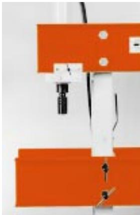
Durch die "offene Ausladung" kann der Zylinder zur schnellen Entfernung des Lagers und anderen Maßnahmen außen am Pressenrahmen montiert werden.
