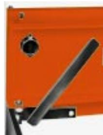
Hebel senkt das Pressenbett zum Pressen und hebt es zum Gleiten.
