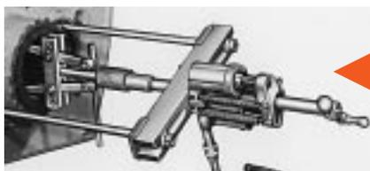
50-Tonnen "Push-Puller" mit Hohlkolbenzylinder und Innanabzieher bei der Demontage einer Antriebswellendichtung.
