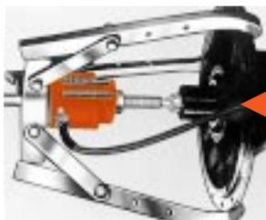
Dreiarmiger Abzieher sorgt für sicheres Greifen, während die Handpumpe hydraulische Kraft zum Abziehen einer Welle vom Gehäuse bewirkt. Wellenschutz am Spindelende schützt vor Beschädigungen.
