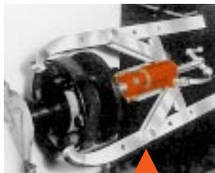
Eine flexible Kupplung wird mit einem 2-armigen Abzieher von einer Elektromotorwelle entfernt.
